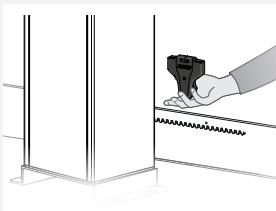
Antes de instalar, debe identificar cuál es el final de carrera de cierre y de apertura. Para ello, bloquee el motor y presione el botón para cerrar el portón. Durante el cierre, pase uno de los fines de carrera en la zona de detección (como en la imagen) para comprobar que el portón se para. Después de identificar los finales de carrera, puede proceder a la instalación.
